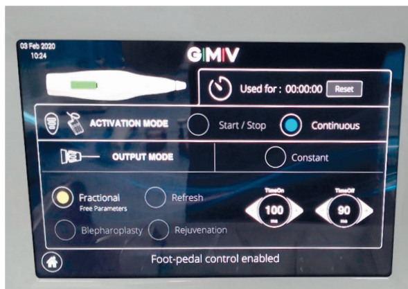
Фигура 2. Екран за настройване на апликатора. Избраната опция за работа е фракционен режим 100 ms в работен режим и пауза от 90 ms.
