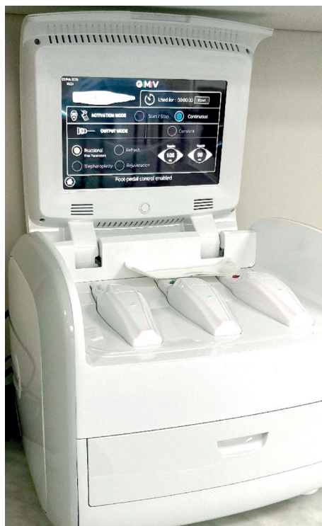
Фигура 1. Плазма генератор Plexr (GMV, Италия). Апликаторите са поставени на конзолата. При работа ръкохватките са свързват безжично с конзолата.
